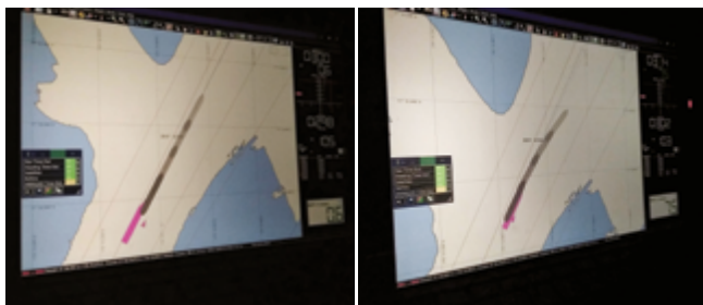
PPU mostrando “GPS Smoothing” (imagem acima) com o navio atrasado e smoothing zerado (abaixo).
